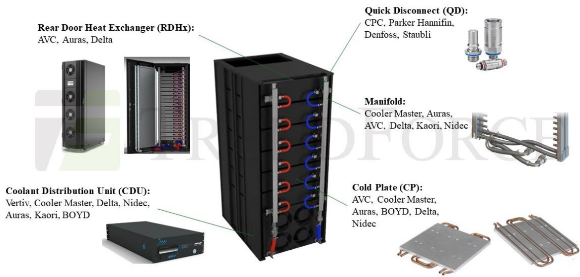
그림51 Rack 단위 냉각 부품 구성
